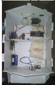
Gambar 12. Gambar Prototype Sistem Monitoring Keamanan, Suhu dan Kelembapan Gudang Beras
