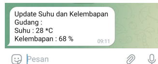
Gambar 10. Notifikasi Suhu dan Kelembapan Otomatis
